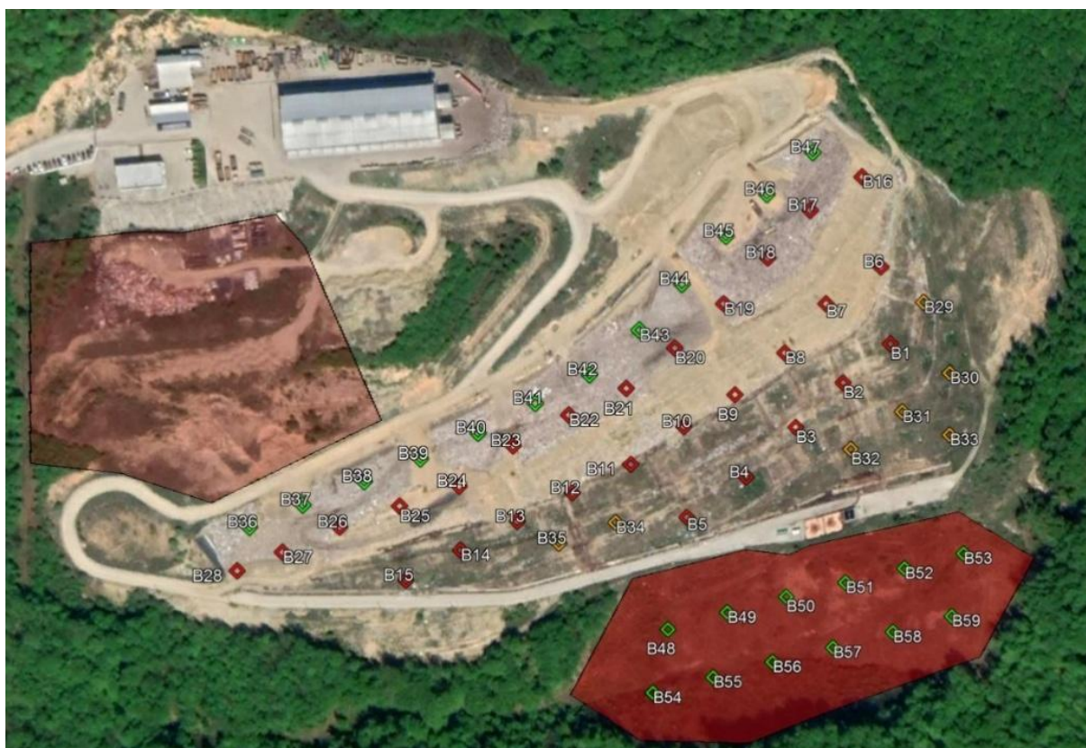
Слика 7.27. Постојећи распоред биотрнова (Б1 – Б28) на санитарној депонији комуналног отпада Дубоко, предложени додатни биотрнови за гасну фазу 1 (Б29 – Б35) и будући биотрнови у гасној фази 2 (Б36-Б59)
