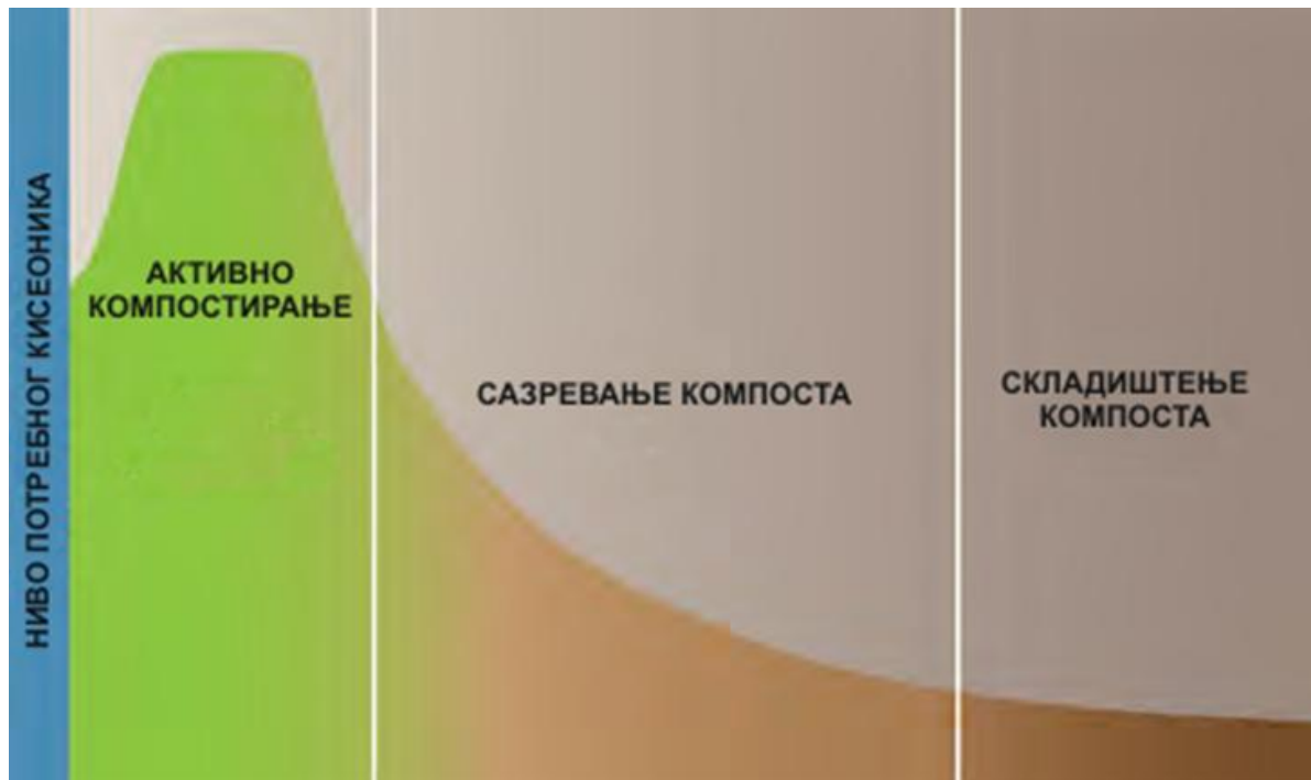
Слика 7.9. Теоретска потреба микроорганизама за кисеоником током процеса компостирања
